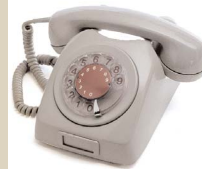
Bordtelefon fra Elektrisk Bureau, modell 1967, verdens første full-transistoriserte telefon.
