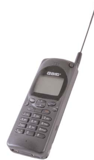
Mobiltelefon for GSM, type Nokia 2110, produsert av Nokia, Finland i 1995. Standbytid 24 timer, taletid 1 time og 30 min. Vekt 332gram.
