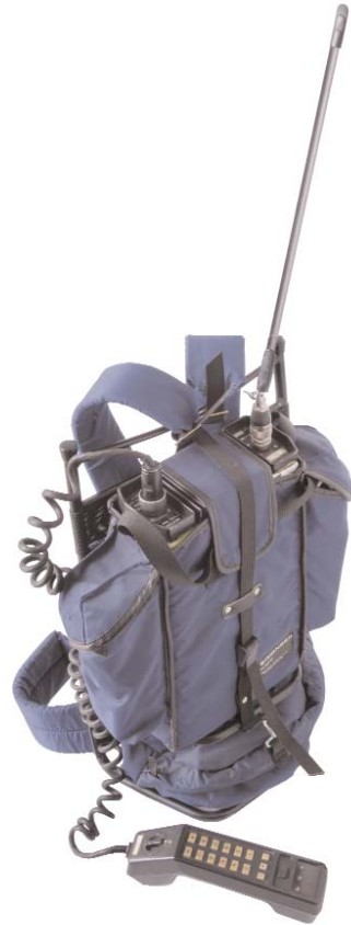
Mobiltelefon for NMT450. Produsert av Simonsen Elektro AS, Norge i peri- oden 1981-83. Vekt 10 kg. Ryggsekken ble spesialsydd av Oslo reiseeffektfabrikk AS.
